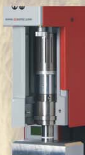
易拆卸之震動子擴大錐度，僅需一只板手即可輕易更換焊頭
