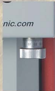
可控制氣缸行程旋鈕，每轉一圈為1mm，精密度達0.01mm
