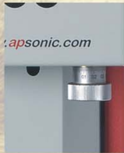
可控制氣缸行程旋鈕，每轉一圈為1mm，精密度達0.01mm
