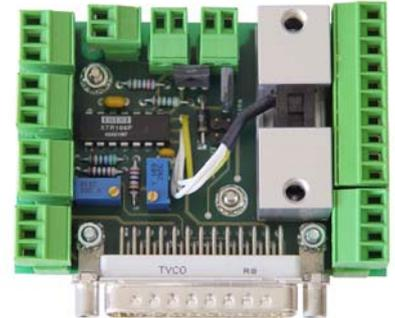
TIP002 是裝配在壓機內控制壓差 Trigger 的介面卡，透過 25 pin D-sub 公接頭直接與 Anaconda 或 Viper 電箱連接，也可以由此接頭連接其它電箱或 PLC 裝置，所有輸入及輸出點均有分離的連接頭，含獨立的 24VDC 電源供應。
